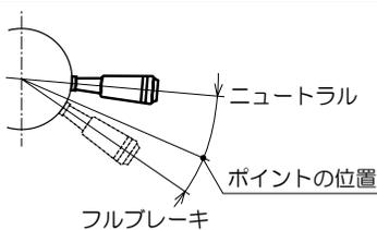
※ポイントの位置からフルブレーキに操作しているときにALBが動作します。
