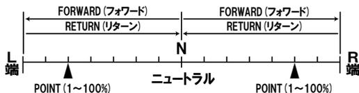
※IN/OUTの設定をすることで、POINT (ポイント) よりも内側 (IN) か外側 (OUT) でスピードの機能を動作させるか設定することができます。
