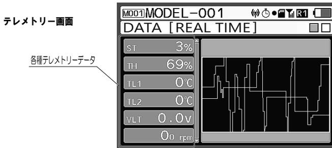
対応する機器と組み合わせてテレメトリー機能をONにすると送信機にデータが送られテレメトリー画面に表示されます。
