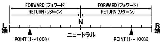
※IN/OUTの設定をすることで、POINT(ポイント)よりも内側(IN)か外側(OUT)でスピードの機能を動作させるか設定することができます。
