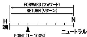
※IN/OUTの設定をすることで、POINT (ポイント) よりも内側 (IN) か外側 (OUT) でスピードの機能を動作させるか設定することができます。
