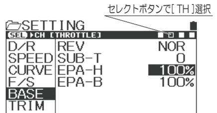
**注意** ●スロットルリンケージでキャプテター全開側、ブレーキ側のEPA設定値が大きすぎるとサーボがロックした状態になりサーボモーターの故障原因となり、暴走の危険があります。
