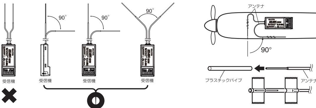
②アンテナ受信部の機体への取り付けは、ノイズレスパイプなどプラスチック製のパイプでアンテナ受信部の保護および固定をしてください。
