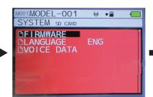
⑥microSDHCカード内のプログラム ファイル名が表示されUPDATE OK? と表示されますので[OK]を選択して、 ENTERします。
